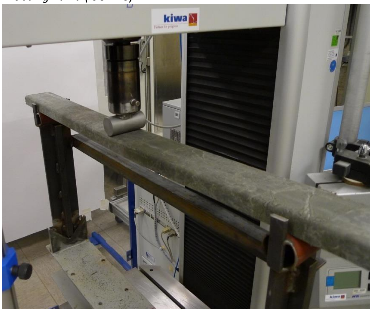
Rys. 2.2 Rozłożenie deski na rusztowanie przy zginaniu trzypunktowym.
