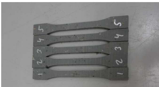
Rys. 2.3 Drążki do rozciągania według normy ISO 527-2 uzyskano z deski
